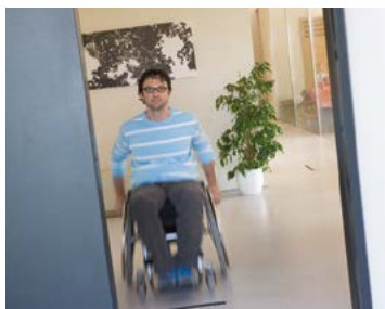
Damit sich die Türen wie von selber öffnen, kann man Tastleisten in den Boden einbauen.
